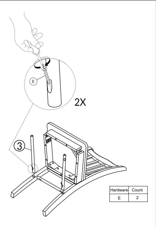
DO NOT TIGHTEN SCREW COMPLETELY.
