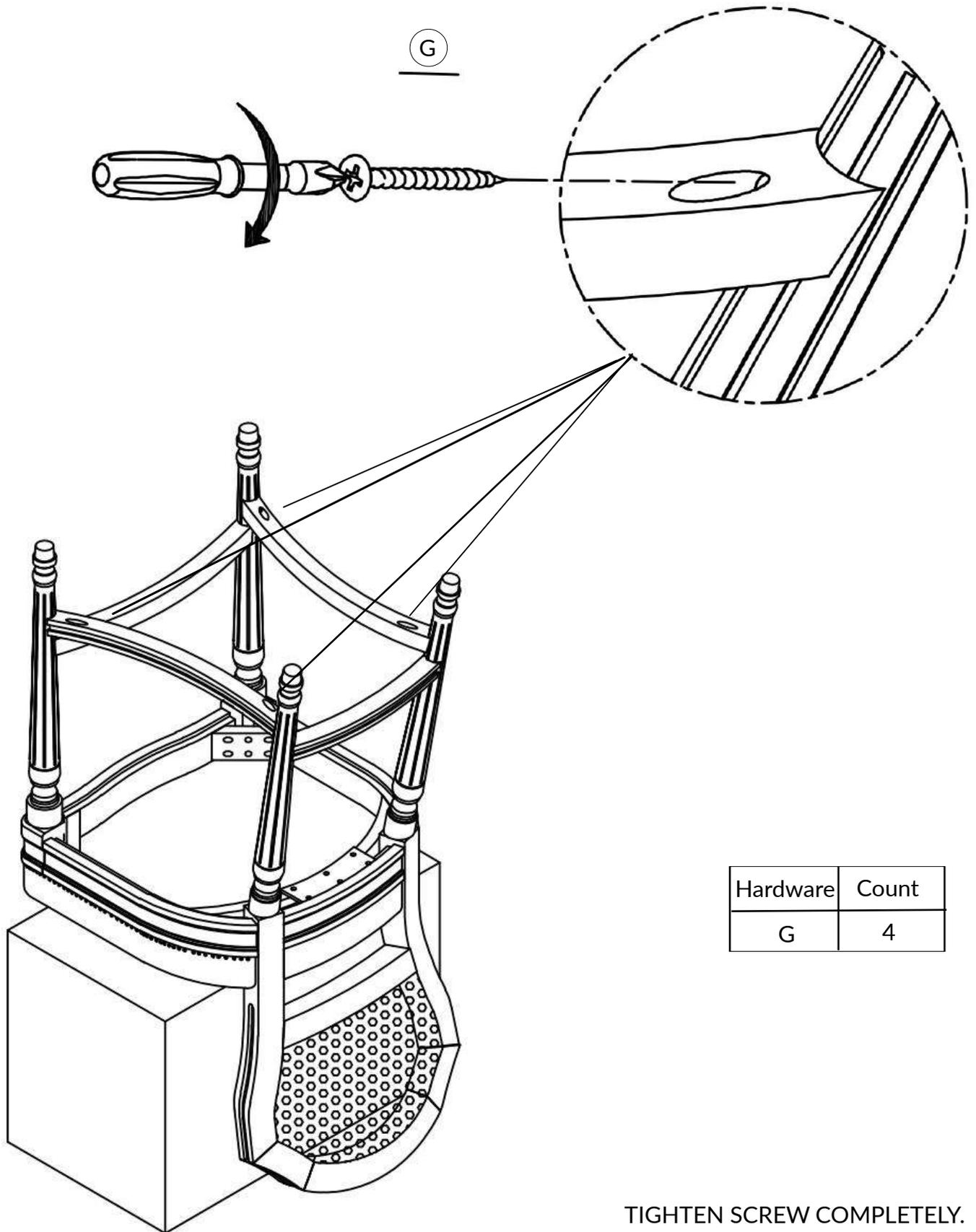
TIGHTEN SCREW COMPLETELY.
