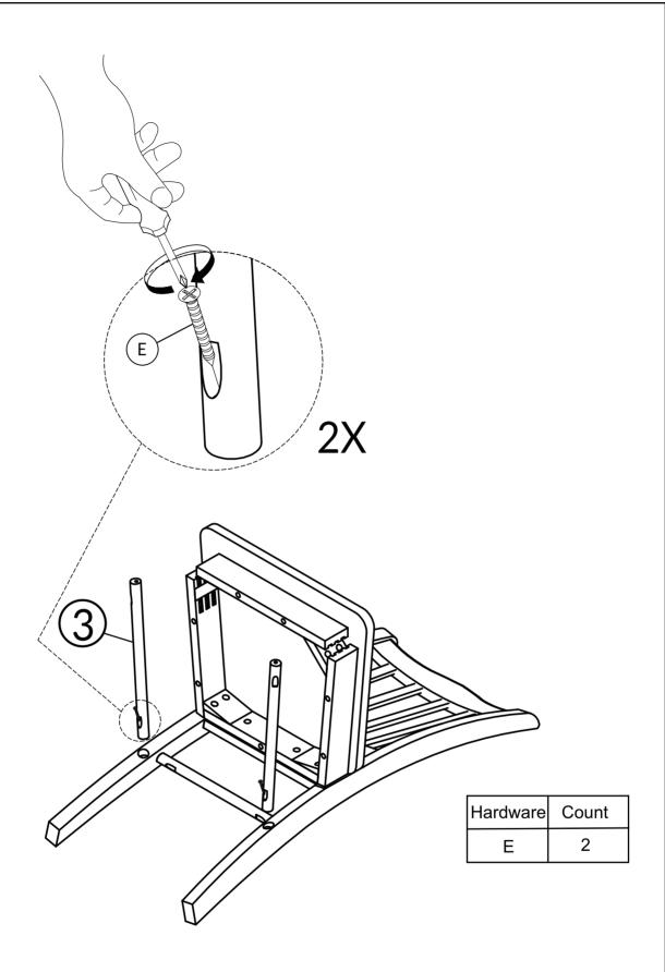
DO NOT TIGHTEN SCREW COMPLETELY.
